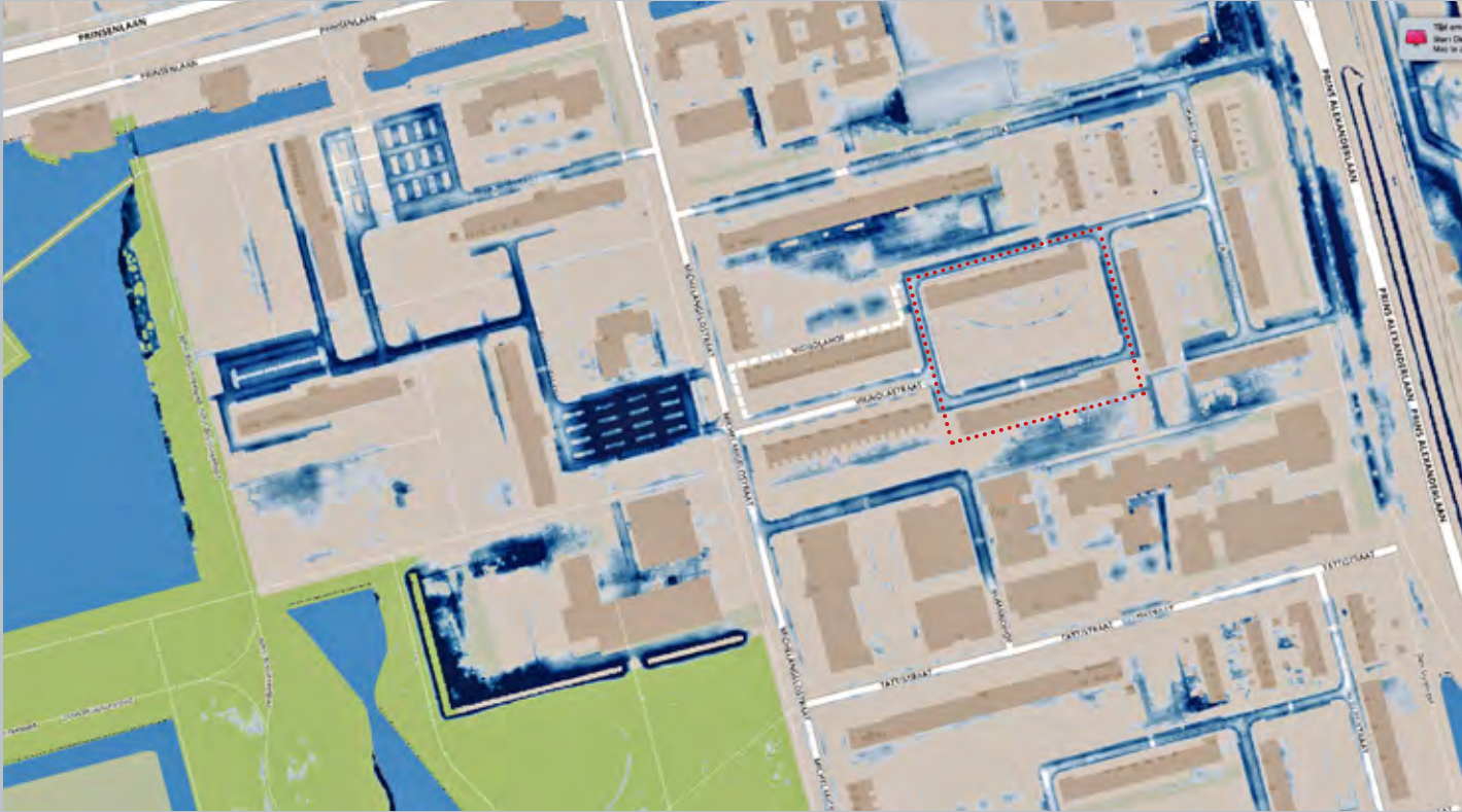
■ veel water op straat ■ weinig water op straat Wateroverlastkaart bij een extreme bui van 100mm in twee uur
