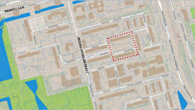
■ veel water op straat ■ weinig water op straat Wateroverlastkaart bij een extreme bui van 100mm in twee uur
