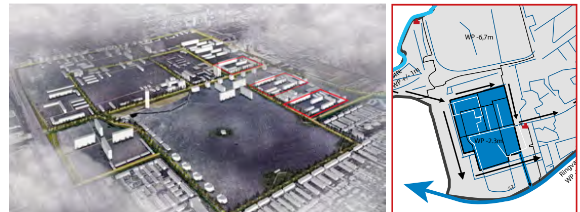
Scenario 3 in vogelvucht / Rechts: nieuw watersysteem met een directe verbinding naar de Ringvaart en een boezemsloot
