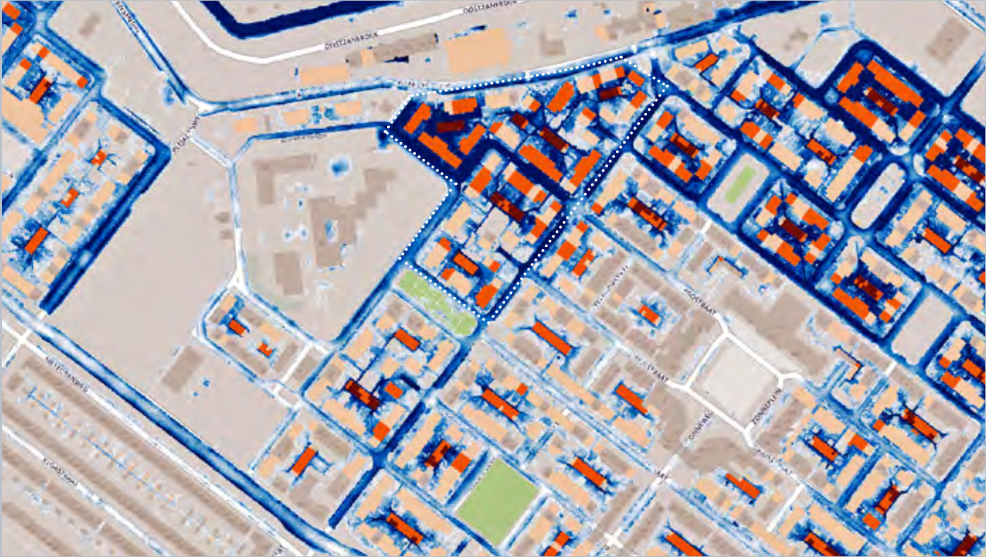
■ veel water op straat ■ weinig water op straat Wateroverlastkaart bij een extreme bui van 120mm in twee uur
