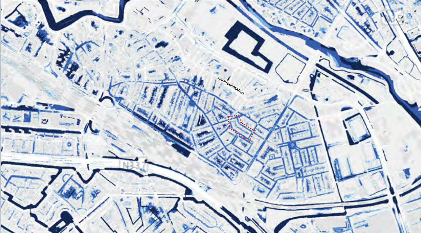
■ veel water op straat ■ weinig water op straat Wateroverlastkaart bij een extreme bui van 67mm in een uur
